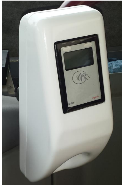
1. ábra: Egyérintéses olvasóval ellátott menetjegy kezelő
